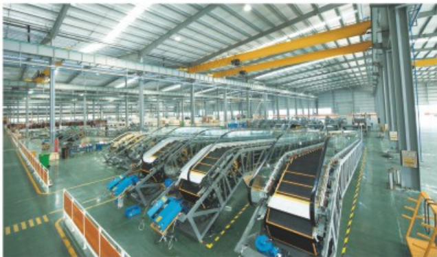
扶梯生产车间
